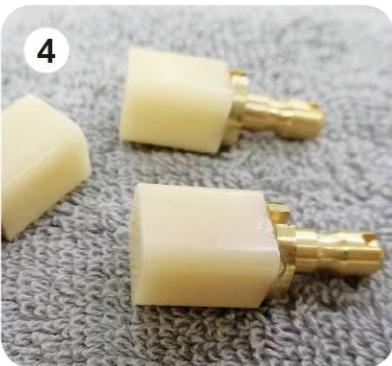
設計が完成したら歯科用ミリングマシンでレジンブロックを切削していきます。
