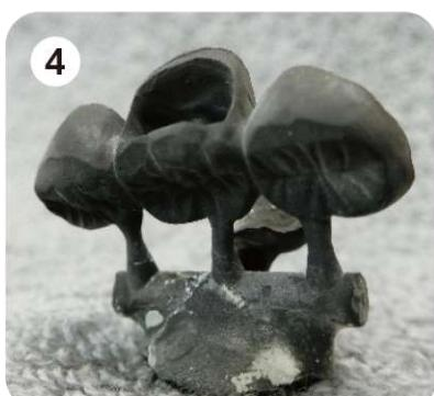
そこへ1000℃近くに熱した金属を流し込み、クラウンを鋳造していきます。
